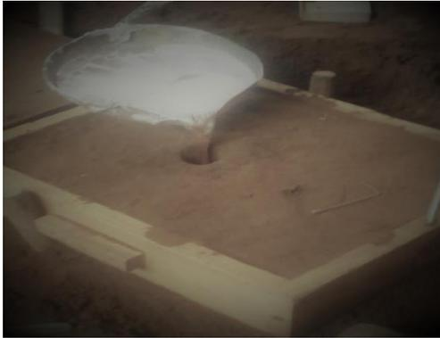
Gambar 4.4. Proses Penuangan Kedalam Cetakan
