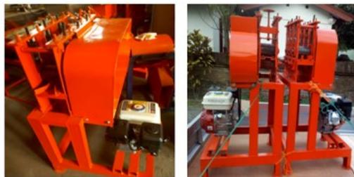
Gambar 6. Mesin irat (penipis) bambu tampak samping
