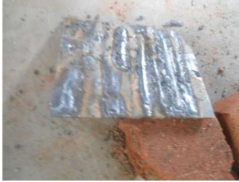
Gambar 7. Gambar Hasil Pembuatan Alur Salah Satu Peserta
