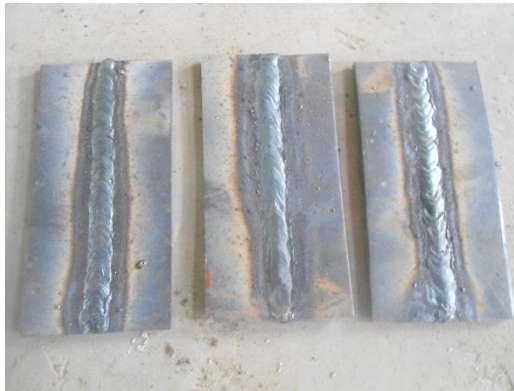
Gambar 8. Hasil Praktek Membuat Sambungan I
