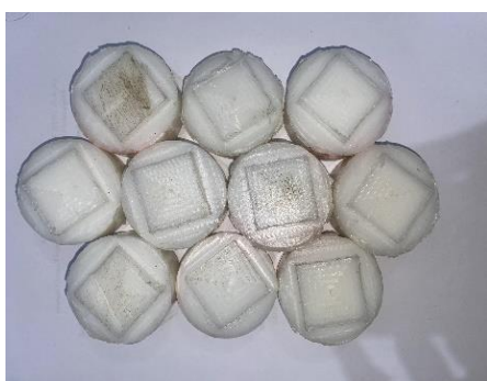
Gambar 8. hasil machining menggunakan CNC SMC
