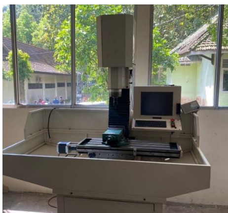
Gambar 3. Mesin CNC Milling dengan control SCM
