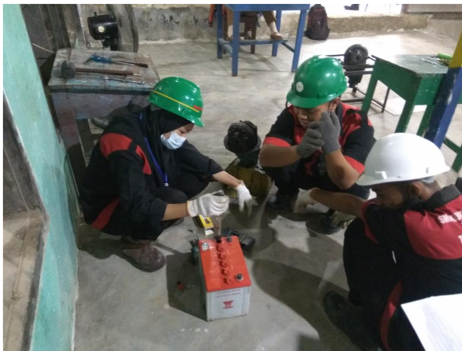
Gambar 1. Pengukuran Berat jenis dan Tegangan pada Accu Sumber. Dokumentasi lapangan
