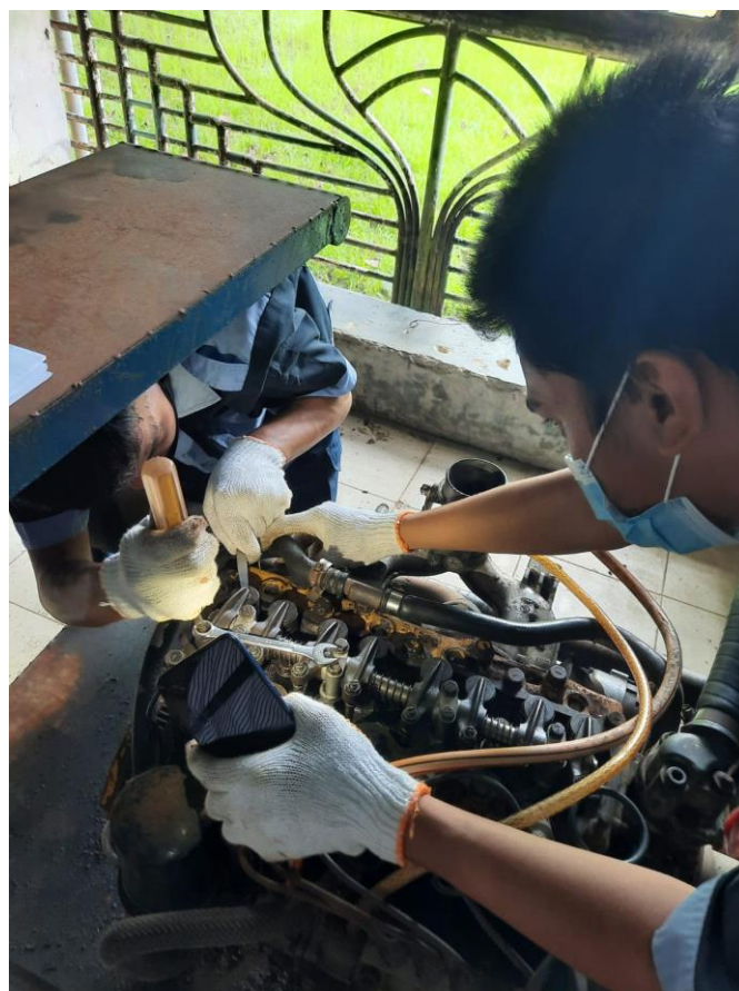
Gambar 2. Siswa melakukan proses penyetelan katup Sumber. Dokumentasi tim lapangan
