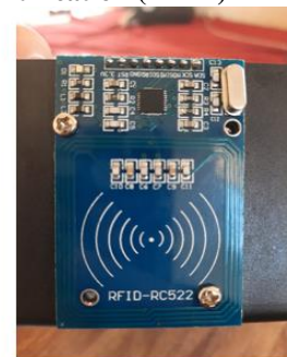
Gambar 10. Rangkaian RFID dibagian atas box
