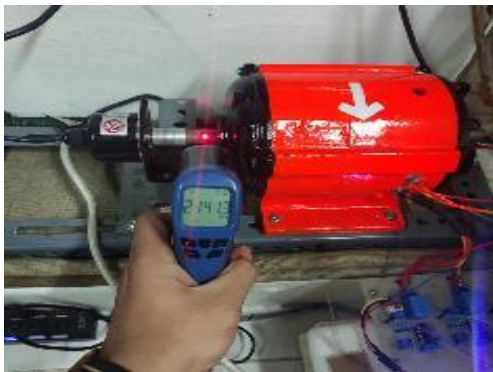
Gambar 12. Hasil pengujian laboratorium kecepatan putaran rotor pada Kondisi-1
