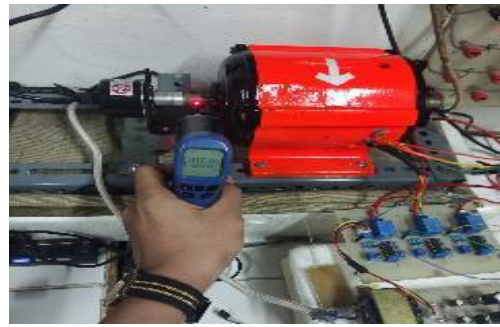
Gambar 14. Hasil pengujian laboratorium kecepatan putaran rotor pada Kondisi-2
