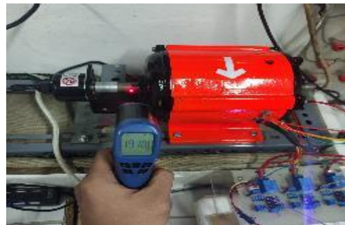
Gambar 16. Hasil pengujian laboratorium kecepatan putaran rotor pada Kondisi-3
