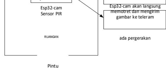
Sistem ini menjelaskan mulai dari terdeteksinya gerakan yang ditangkap oleh sensor *PIR* hingga mengambil gambar dan mengirimkan hasil gambar ke telegram.
