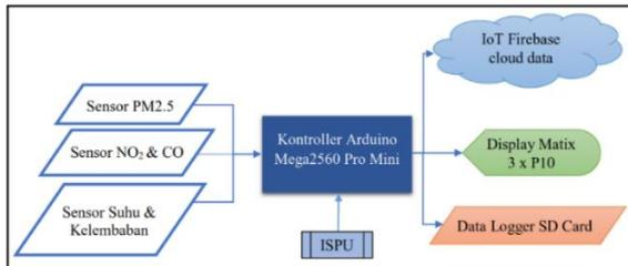
Gambar 3 Konfigurasi Sistem Alat Ukur Kualitas Udara
