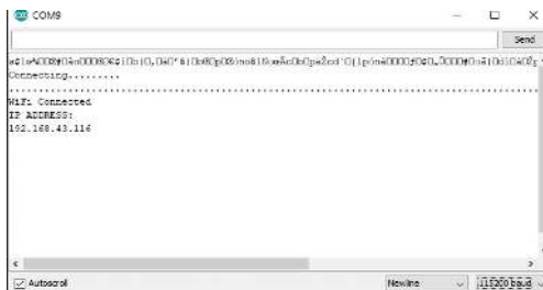
Gambar 19. Pengujian IP Address pada NodeMCU ESP8266
