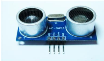
Gambar 2. Sensor ultrasonik HC-SR04 Sumber: (Datasheet HC-SR04)
