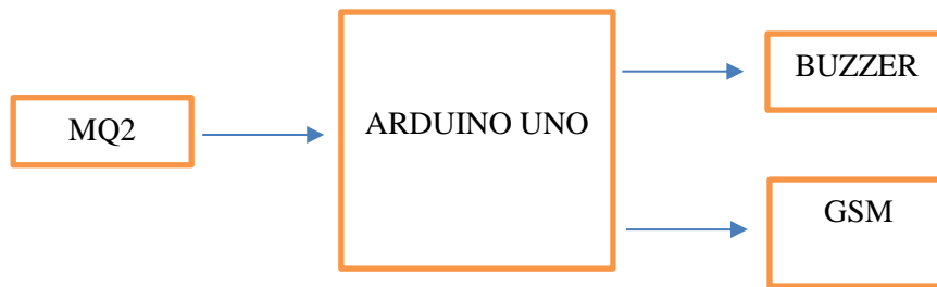
Gambar 3. Diagram Blok Sistem Pendeteksi Asap Rokok
