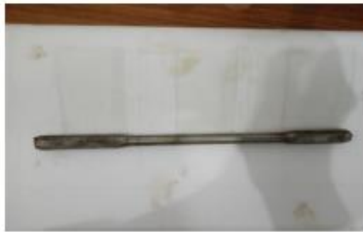
Gambar 2 Spesimen sebelum dilakukan pengujian puntir
