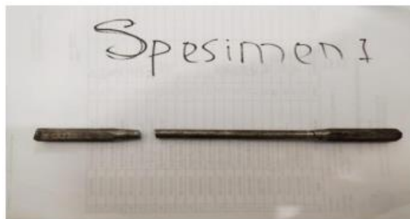
Gambar 3 Spesimen sesudah dilakukan pengujian puntir
