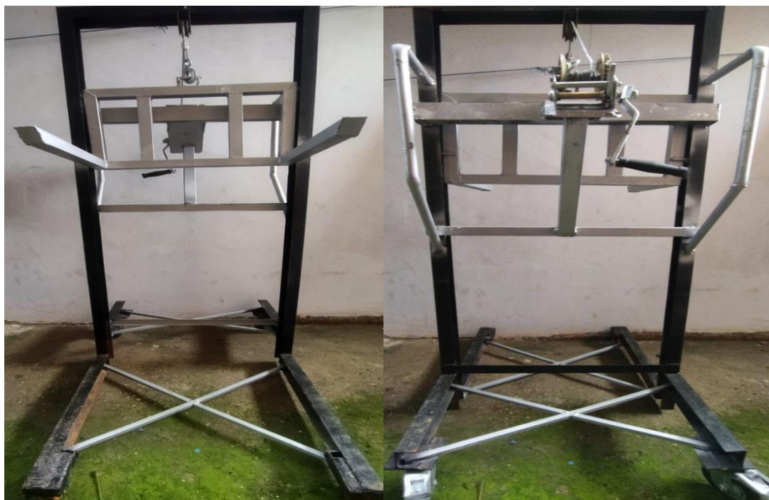
Gambar 3. Hasil rancangan forklift kapasitas 100 kg
