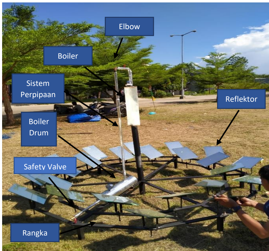
Gambar 6. Alat pembangkit uap menggunakan energi surya yang telah dipasang cermin
