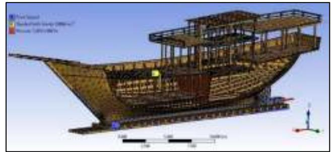
**Gambar 4.** 3D solid konstruksi kapal, kondisi batas, and pre-analisis
