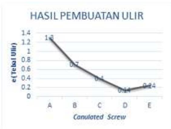
Gambar 15. Grafik Hasil pembuatan canulated screw
