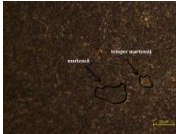
Gambar 6. Hasil Foto Uji Struktur Mikro OM Baja AISI 1045 (c) Perlakuan Panas Tempering Variasi Temperature 450 °C
