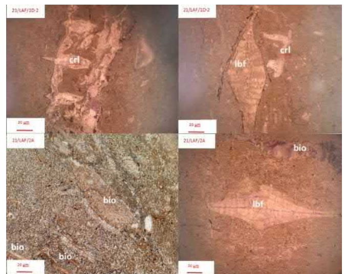
Gambar 2. Petrografi wackestone dengan komponen bioklastika (Bio), Koral (crl), didominasi matriks lumpur karbonat. Terdapat foraminifera Lepidocyclina , sp.
