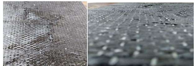
Gambar 10. Delaminasi pada serat.
