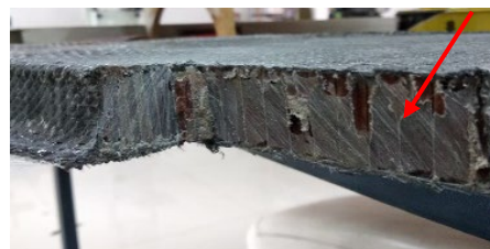
Gambar 11. Resin masuk dalam core.
