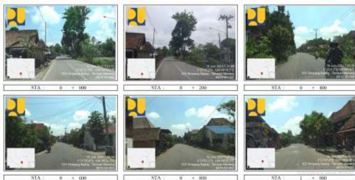
Gambar 4. Contoh Pengambilan foto tagging per 200 meter pada ruas jalan Simpang Kijang - Terusan Menang, Kabupaten Ogan Komering Ilir
