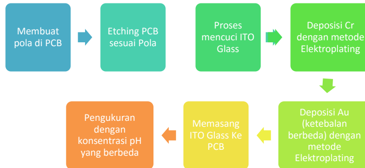
Gambar 2. Diagram proses pembuatan lapisan pendeteksi di ITO Glass untuk Gold-EGFET
