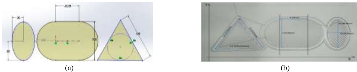
Gambar 5 (a). Desain 2D pada Solidwork , dan (b). Hasil Cetak Desain 2D
