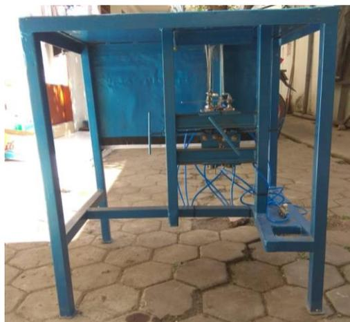
Gambar 5. Hasil pembuatan Pneumatik pada Alat Pemasang Tali Sandal
