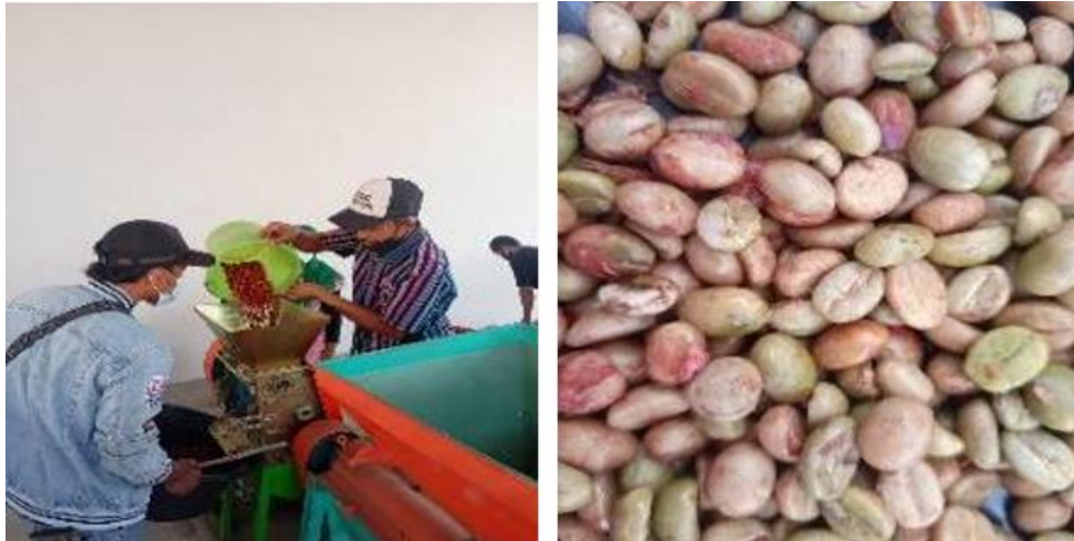
Gambar 2. Pemisahan Pulp Dari Buah Kopi dan Biji Kopi dengan Pulper
