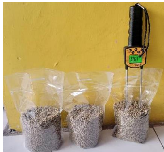
Gambar 7. Pengukuran Kadar Air pada Saat Pengemasan
