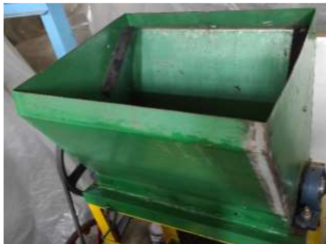
Gambar 6. Proses Pembuatan Hooper
