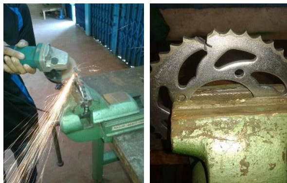
Gambar 1. Proses Pemotongan Material Gear Sprocket
