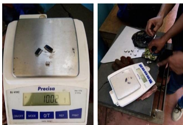
Gambar 2. Proses Penimbangan Material Gear dan Timah Sebagai Perbandingan
