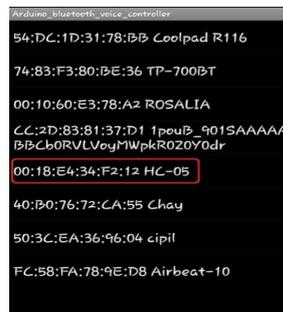
Gambar 6. Menghubungkan Android dengan Modul Bluetooth HC-05
