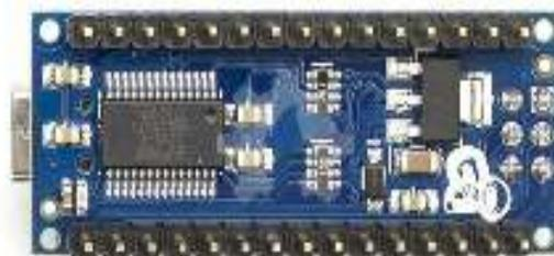
Gambar 1. Mikrokontroler Arduino Nano
