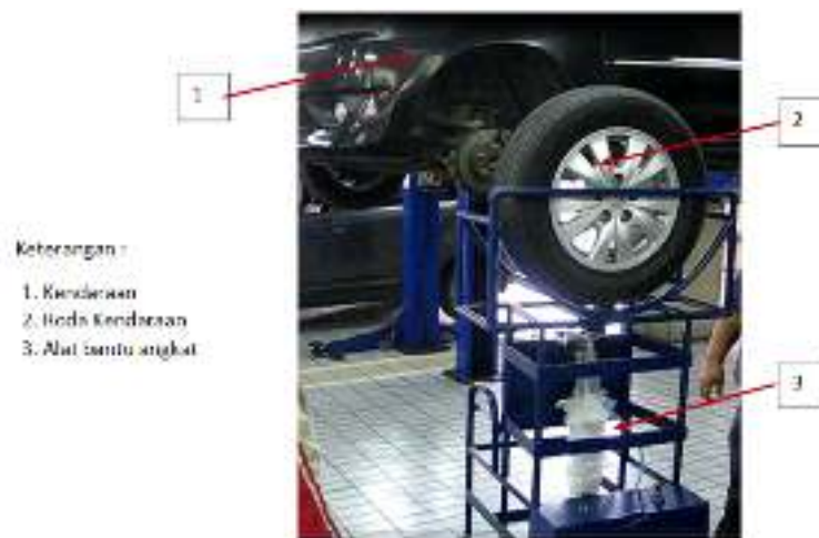
Gambar 3. Alat angkat sistim pneumatik lepas/pasang roda kendaraan.
