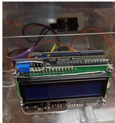
Gambar 8. Tampilan LCD Keypad Shiled terhubung ke Arduino.
