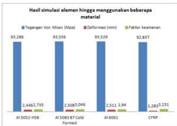
Grafik 1. Hasil simulasi elemen hingga menggunakan beberapa material
