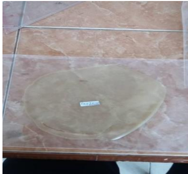
Gambar 2a. Bioplastik dengan formulasi pati-gelatin 7,5 : 2,5 (g/g) dan MFC 1%
