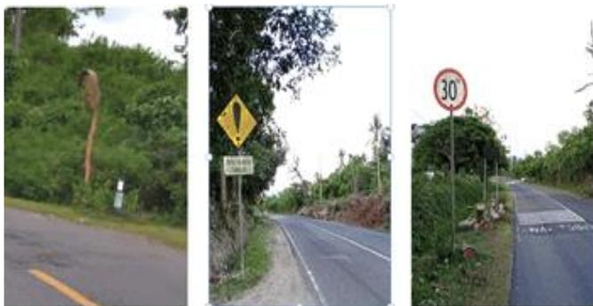
Gambar 4. Rambu Lalu Lintas (*Safety Mirror*, *Safety Sign* dan *Batas Kecepatan*)
