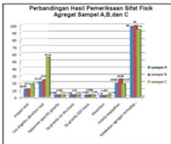
Gambar 2. Perbandingan hasil pemeriksaan karakteristik agregat sampel A, B dan C
