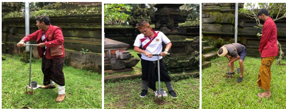
Gambar 2. Penggalian Lubang Tanah Menggunakan Alat Bot Tanah
