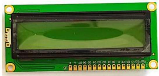
Gambar 7. LCD 16x2
