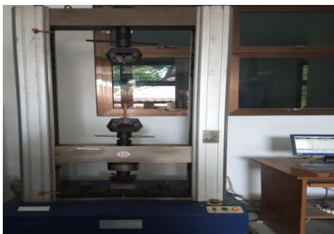
Gambar 2 Alat uji tarik dan uji lentur
