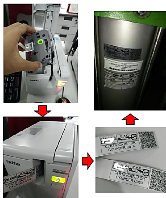
Gambar 7. Proses cetak label QR-Code sampai pemasangan pada Hydroulic dan Pneumatic
