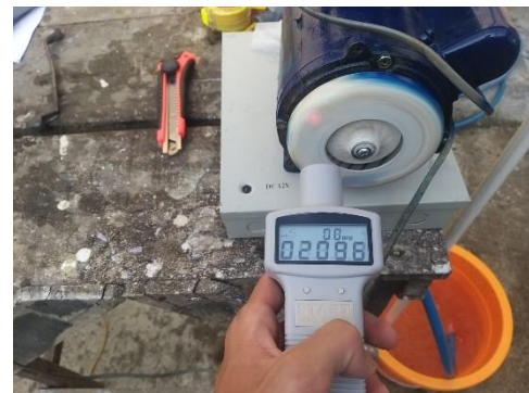
Gambar 3.8 Pengukuran RPM menggunakan tachometer.
