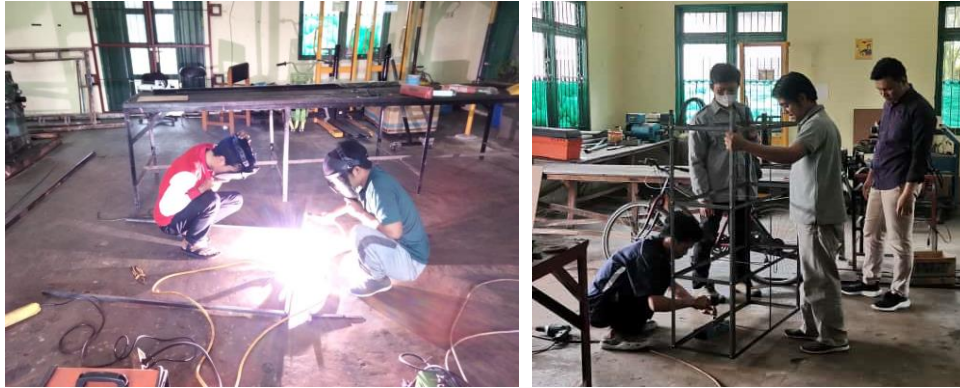
Gambar 3. Proses Pengelasan Rangka dan Proses Pengeboran Plat
