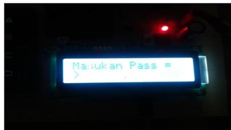
**Gambar 16.** Tampilan LCD Setelah RFID Tag Didekatkan Dengan RFID Reader
