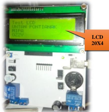
**Gambar 16.** Foto Dokumentasi Pengujian Mikrokontroler ATmega8 dan LCD 20x4
