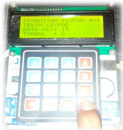
**Gambar 17.** Pengujian Rangkaian Interface Keypad 4x4
