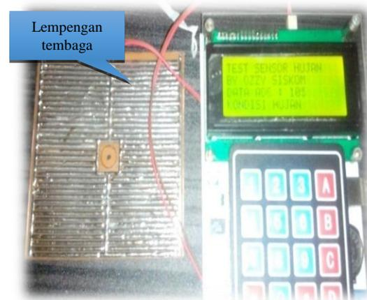
**Gambar 18.** Dokumentasi Pengujian Rangkaian Sensor Hujan
