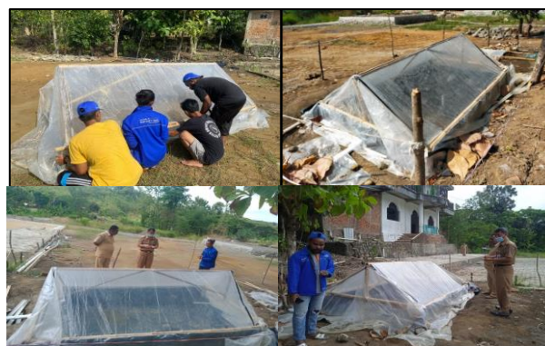
Gambar 7. Pembuatan Alat Destilasi Sederhana
