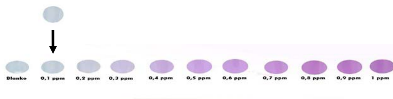
Gambar 4. Penentuan konsentrasi sampel Cr(VI) menggunakan tes kit kromium
