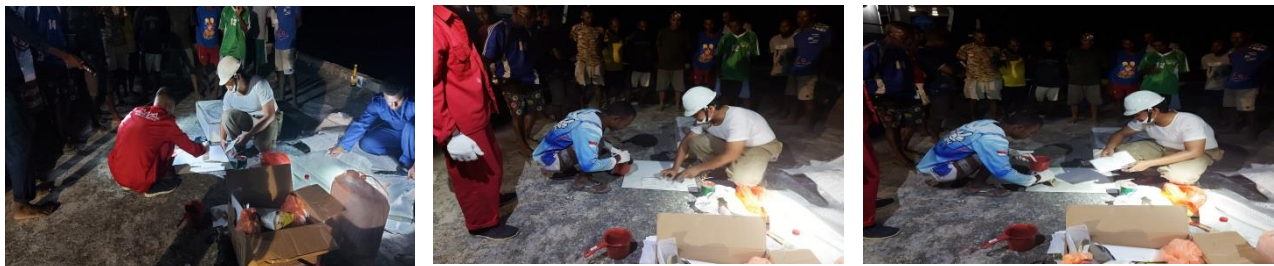
Gambar 10. Penambalan kapal menggunakan teknik penambalan Hand Lay Up
