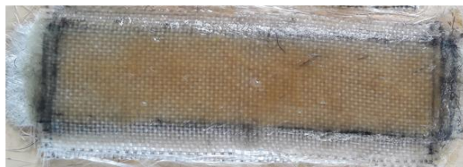
Gambar 11. Hasil praktik menggunakan metode Hand Lay Up oleh masyarakat Abidon
