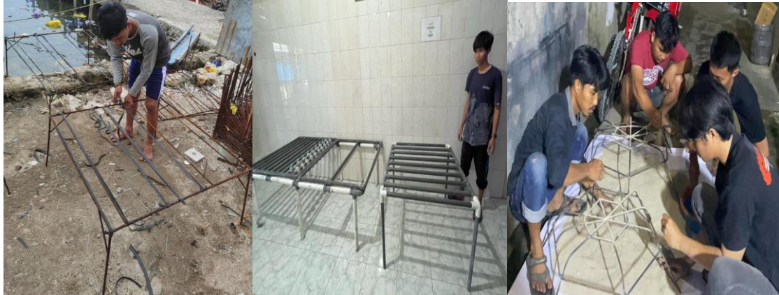
Figure 7. Desain Konstruksi Meja Tranplantasi Karang Hias dan Heksagonal Karang.
