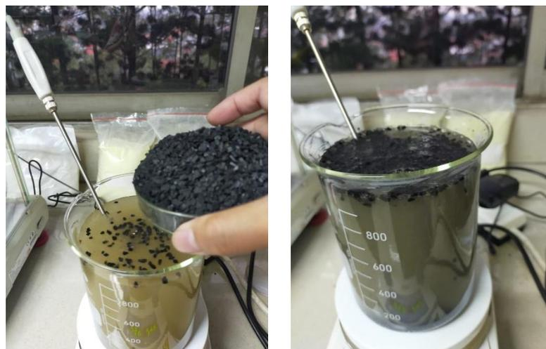
Gambar 2 Uji coba adsorben karbon aktif
