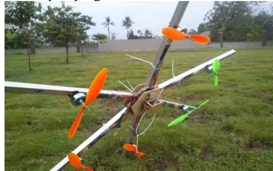
Gambar 8. Heksacopter Crash Saat Uji Coba Terbang
